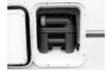
7 Außenklappe für Gasflaschenkasten
